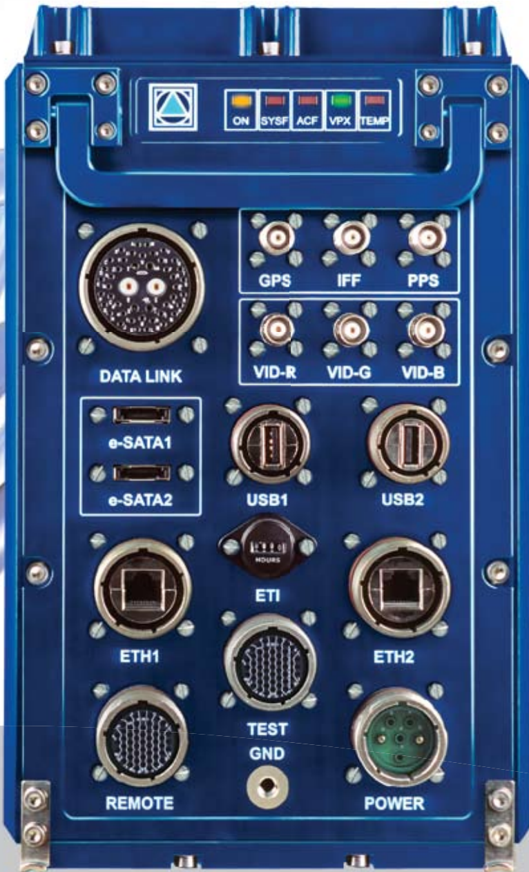
CM-ATR-25/SIXHEX-16HP : 1/2 ATR, 5 Slot 6U, 575W PSU, 9Kg
